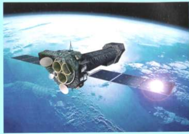
XMM-Newton: satelit ESA, lansiran 1999. godine. Ima 3 rendgenska teleskopa, kao i teleskope za vidljivo i UV zračenje
