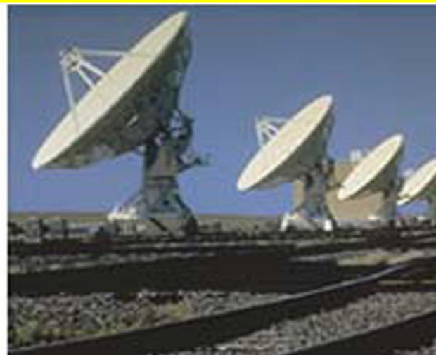
Interferometar u Novom Meksiku (dužina "krsta" 30 km sa 27 radio-antena)
