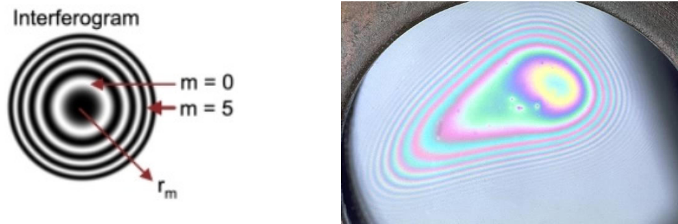
Slika 1.8. Interferenciona šara dobijena Majkelsonovim interferometrom.
